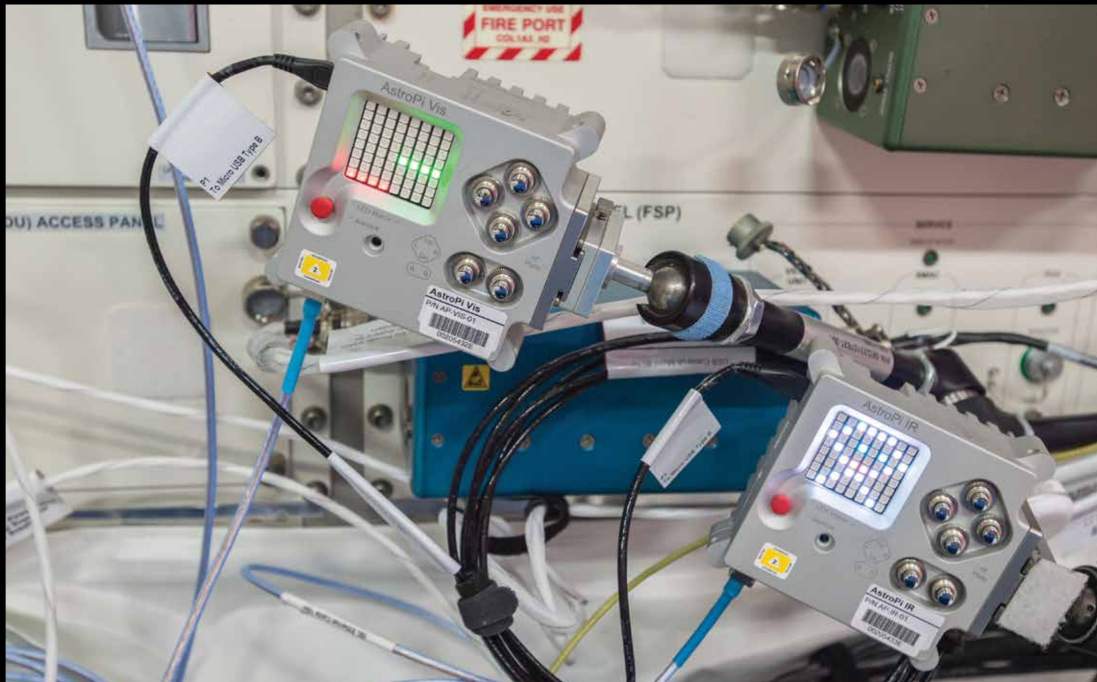
Astro Pi-Minicomputer führen von Studenten entwickelte Codes an Bord der ISS aus (ESA/NASA)
