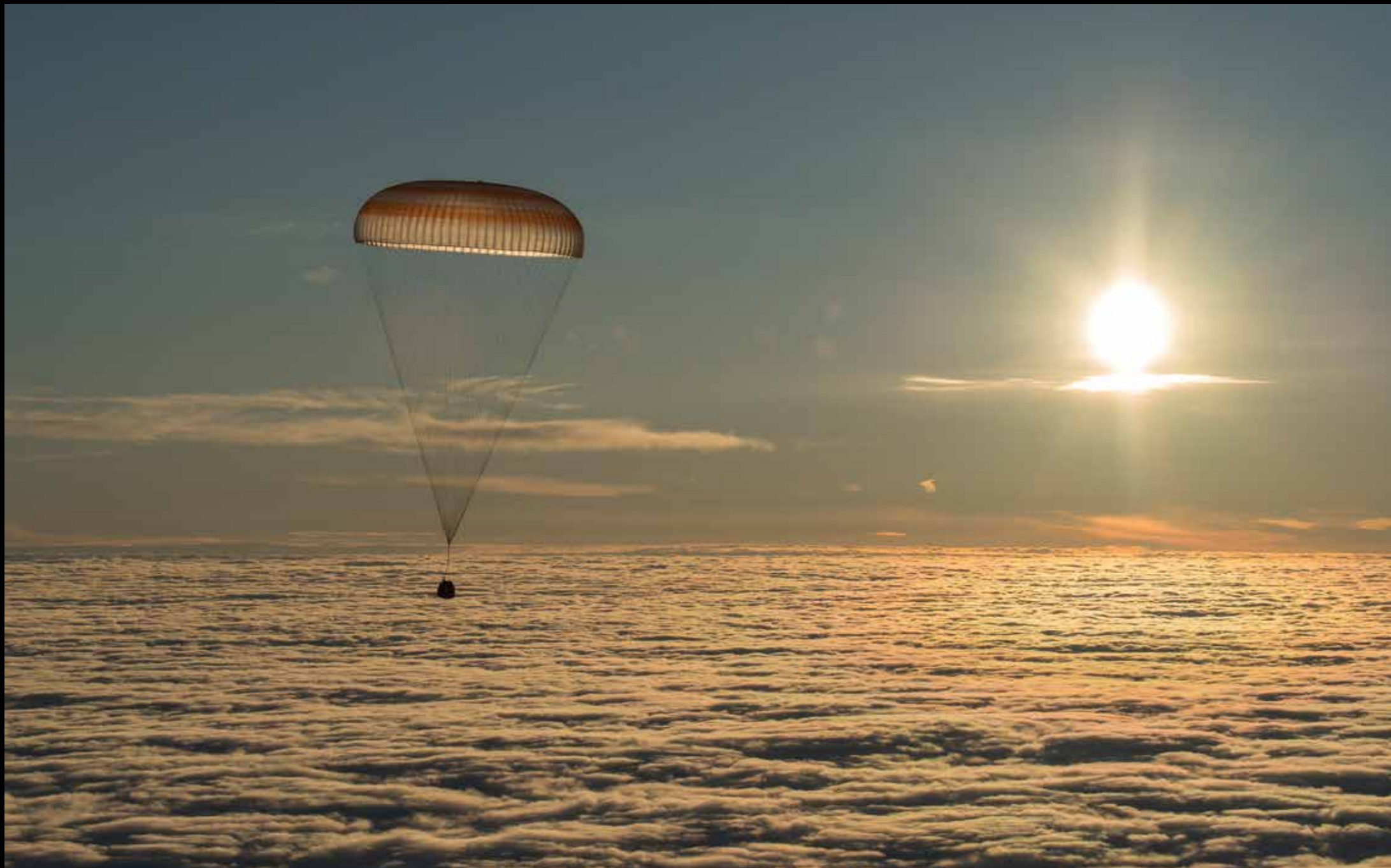
Drei Stunden nach dem Abdocken von der ISS entfalten sich am Abstiegsmodul der Sojus eine Reihe von Fallschirmen. Diese sorgen für ein stabiles Absinken mit einer Geschwindigkeit von etwa 7 m/s (NASA)
