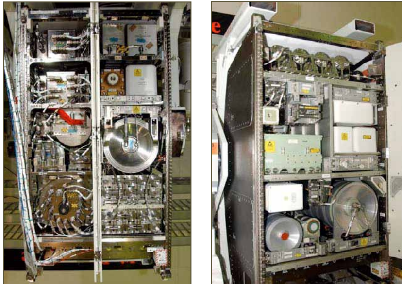
Das WRS (Water Recovery System – Wasserrückgewinnungssystem), Teil des ECLSS (Environmental Control and Life Support System – Lebenserhaltungssystem) der ISS (Bild: NASA)
