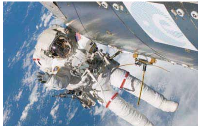
Astronaut Randolph Bresnik am 21. November 2009 beim Anbringen der entfalten AIS-Antenne am Columbus-Modul im Rahmen des Außenbordeinsatzes EVA 2 der Atlantis-Mission. Die Antenne dient im Experiment zur Nachverfolgung der VHF-Signale von Schiffen auf See. (Quelle: NASA)
