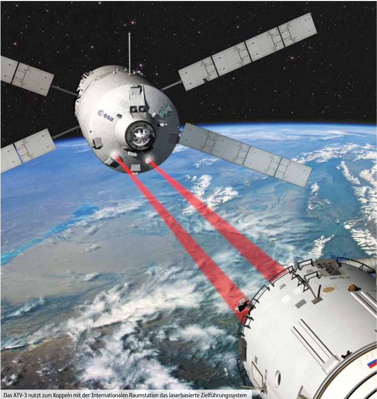
Das ATV-3 nutzt zum Koppeln mit der Internationalen Raumstation das laserbasierte Zielführungssystem
